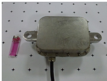
Рис. 1. Датчик ОДТиТ-7 для установки в гирлянды с арматурой 7-тонного ряда
